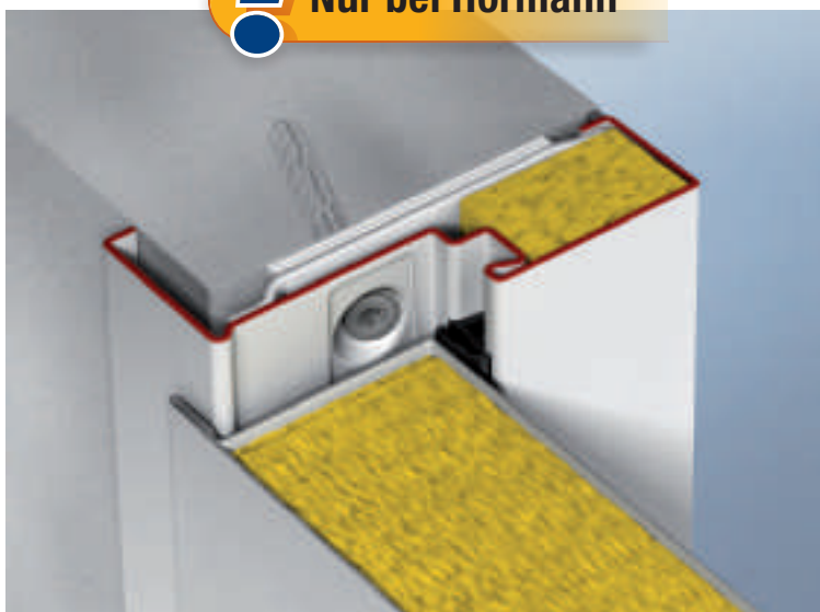
DryFix Zarge mit werkseitiger Mineralwollfüllung und verdeckter Diagonal-Befestigung im Zargenfalz.
