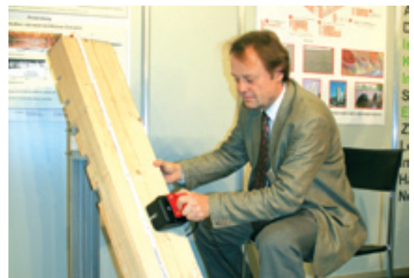
METHODE zur zerstörungsfreien Untersuchung von Holzbalken: Ein Forschungsprojekt der BAM und dem BAKA.
