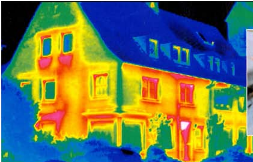
Der Check durch einen Fachmann vor Ort, unter Umständen auch mit Hilfe einer Thermografie, zeigt Ihnen Schwachstellen eines Hauses auf.
