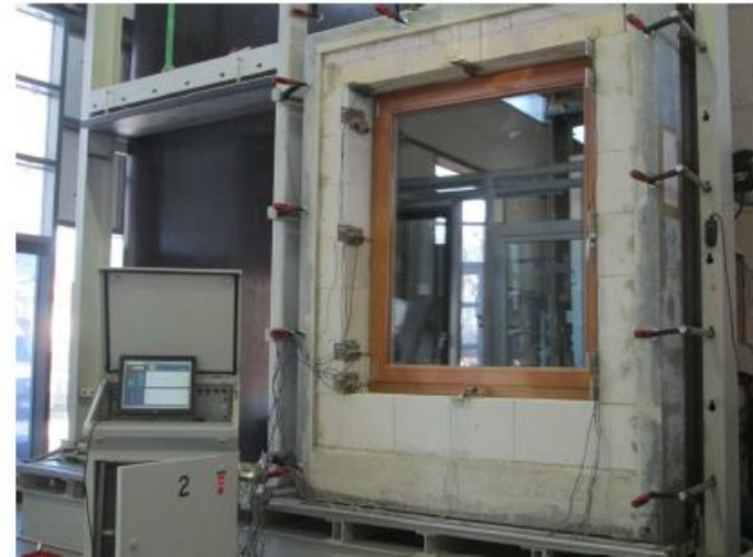
Bild 7 Ansicht Probekörper mit angebrachten Messstellen
