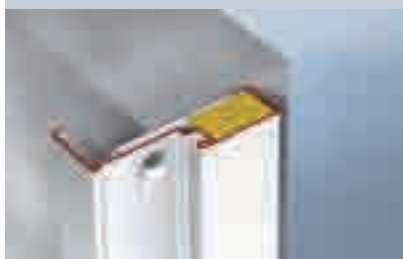
DryFix Zarge mit werkseitiger Mineralwollfüllung und verdeckter Diagonal-Befestigung im Zargenfalz.
